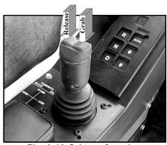
Fig. 3-18 Gripper function
